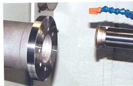
Das außen- und plan-geschliffene Teil kann in der gleichen Aufspannung innen rundgeschliffen werden. Auch Außengewinde lassen sich so schleifen
