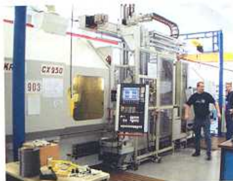
Schleifzelle für die Feinbearbeitung von Verzahnungen aller Art, wie sie bei Kapp in Coburg entstehen. Klar, dass die Einzelteile dieser Hochpräzisionsmaschinen um noch eine Klasse präziser gefertigt werden müssen
