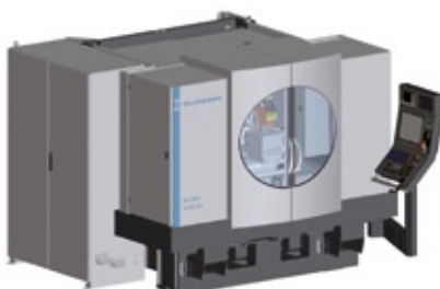
Nah beieinander: vom Panel der bewährten, sehr leistungsmächtigen ‚GrindPlusIT‘-CNC (sie basiert auf der nicht minder bewährten ‚iTNC530‘ von Heidenhain) hat der Operator ungehinderten Blick in den Arbeitsraum der ‚KelVera‘.
