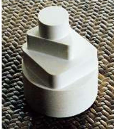
Rechts: Dank der nun an die ‚KelVaria‘ adaptierten ‚GrindPlusIT‘-Steuerung und der adäquaten hoch-dynamischen Antriebstechnik werden Polygone jetzt zweimal und Rund-Excenter sogar dreimal schneller bearbeitet als zuvor.
